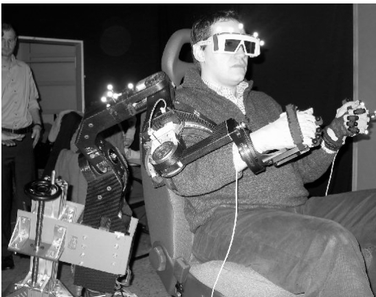
Fig. 2 Système pour simulation de conduite de véhicule, avec dispositif haptique à retour de force pour la main et le bras (exosquelette), PERCRO SSSA, Pisa (image inédite)
